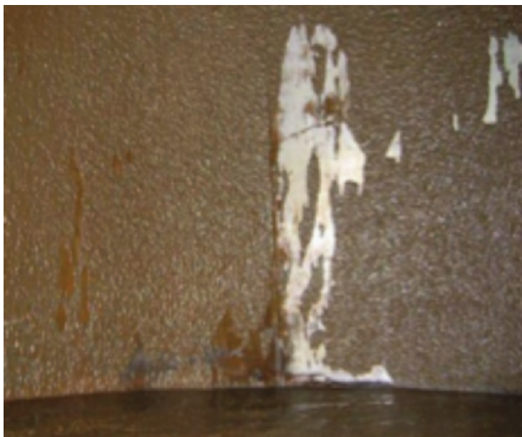
Figura 5 a sinistra: prima del programma: le pareti della tina delle acque prime mostrano elevati livelli di deposito.
